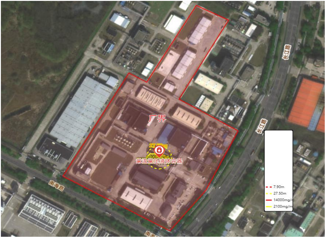
图 6.7-1 甲苯泄漏事故（最不利气象条件）下风向浓度变化图
