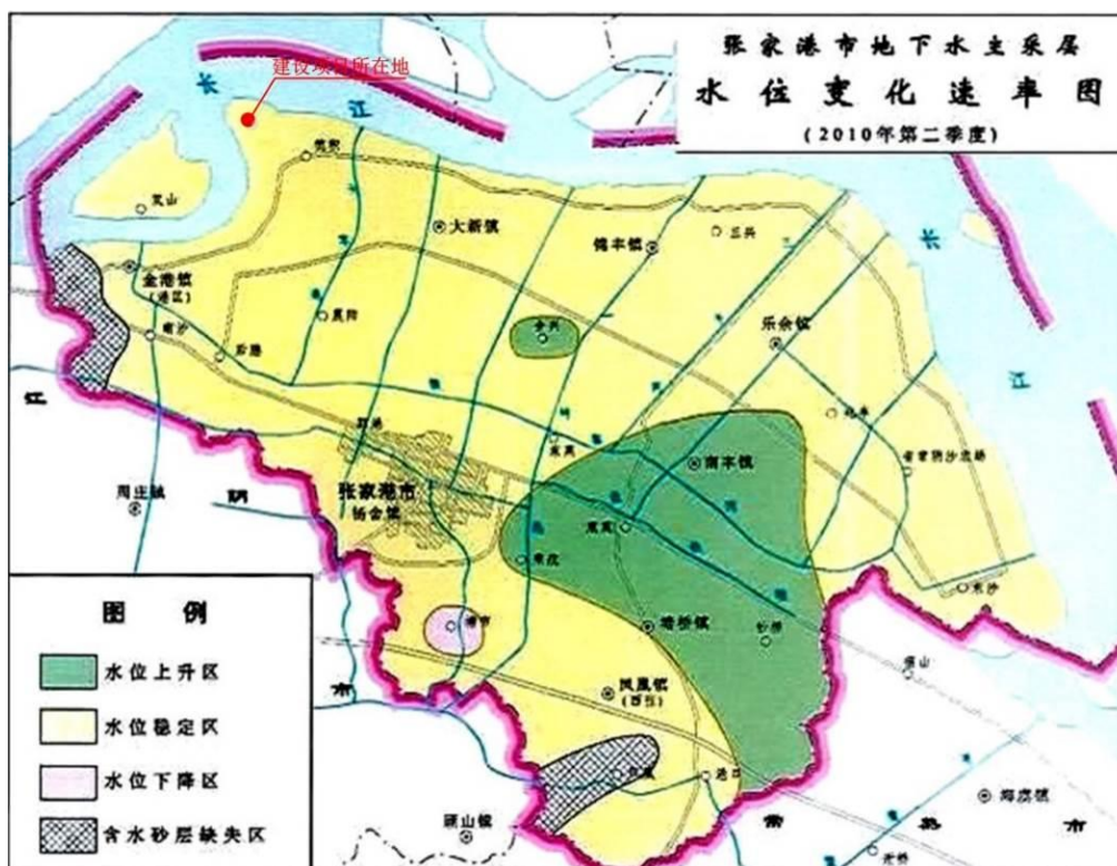
图 5.1-6 地下水水位变化速率图
