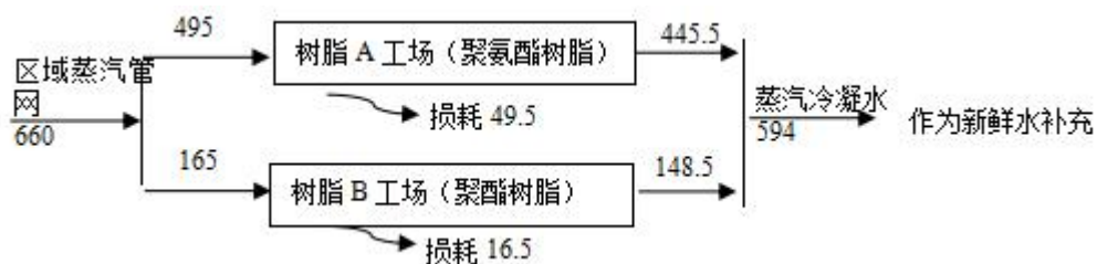
图 4.4-9 本项目蒸汽平衡示意图 (单位: t/a)
